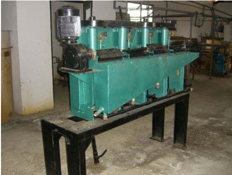
Celdas de flotación
